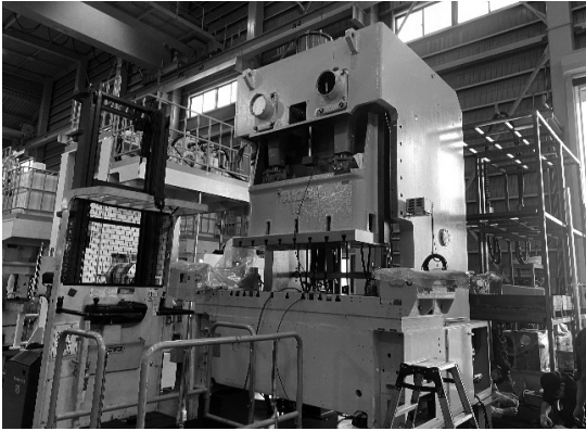
写真5 160tメカ式トランスファプレス
