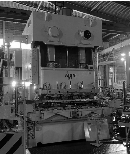
写真6 250tメカ付きトランスファプレス
