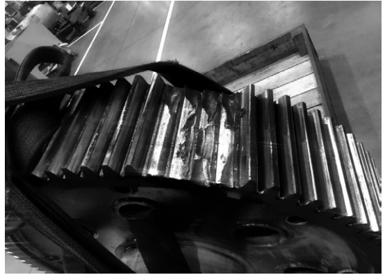
写真7 歯面が崩壊したメインギヤ
